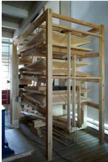
Boven- en dwarsaanzicht van de gereconstrueerde balgstoel met zijn drie balgen. Tijdens de ingebruikname werd de wind getreden door Erik Stolk, één van de medewerkers van Hans van Rossum.
